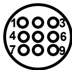
X1 Вид со стороны установки контактов (розетка)
